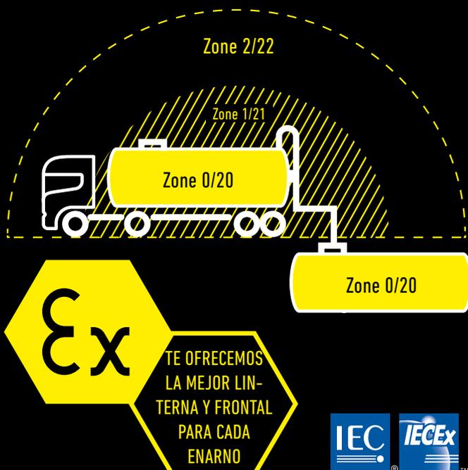
Un lugar en el que una atmósfera explosiva consistente en una mezcla con aire de sustancias peligrosas en forma de gas, vapor o una nube de polvo combustible esta **continuamente presente** o largos períodos o con frecuencia (por ejemplo, en tanques de gas o elevadores de grano).
